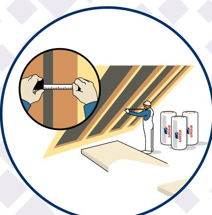
Změříme si šířku rozteče krovkí. Pro zajištění lepší fixace minerální izolace URSA PUREONE DF 39 mezi krovkami přidáme k naměřenému rozměru ještě 2 cm.
