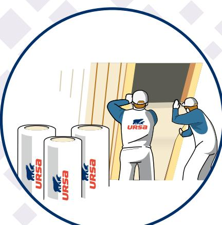
Aplikace minerální izolace URSA PUREONE DF 39 mezi krovky. Izolaci mezi krovky postupně vkládáme lehkým vtlačením po obou stranách její výšky, až zaplníme celé krovkové pole. K zajištění izolace v krovkovém poli při aplikaci použijte fixační prvky např. drátkování.
